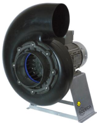
Extracteurs centrifuges de simple aspiration en matériel plastique antistatique ATEX. Certification ATEX 2G ou 2D avec moteur antidéflagrant Ex db, sécurité accrue Ex eb ou protection par virole Ex tb, pour travailler en atmosphères explosives de gaz ou de poussières.
